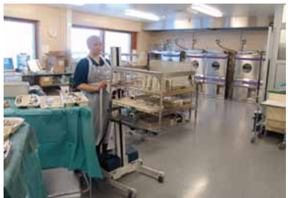
Kuva 2. Pesuhäkit siirretään pesukoneisiin nostolaitteella.
