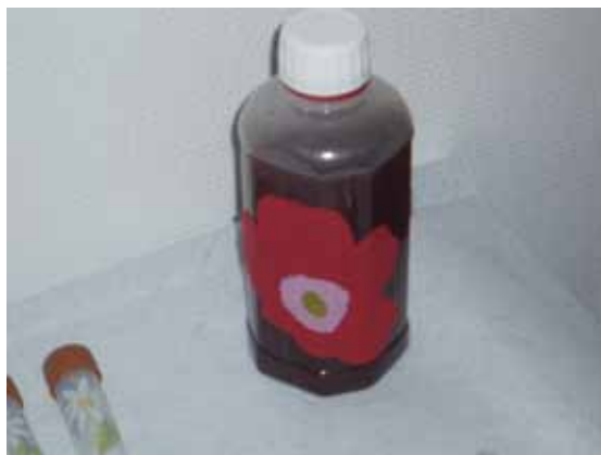
Kuva 2. Luovutuspurkit avataan ja sujutetaan pulloon, korkki suljetaan tiiviisti. Pulloa ravistellaan ja suspensio on valmis siivilöitäväksi.
