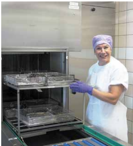
KUVA 2. Instrumenttien puhdistaminen ja desinfektio tunnelipesukoneessa
