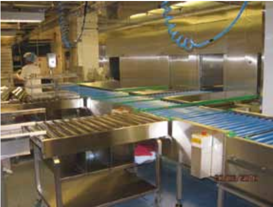
Kuva 2. Vaakasuuntainen siirtäminen tapahtuu kuljetinradoilla.
