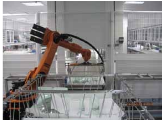
Kuva 1. Kuormaus- ja purkurobotti poistaa raskaan käsin tehtävän työn.
