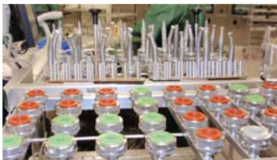
Kuva 3. Hammasvälineiden kulmakappaleiden pesuteline. Telineessä oleviin ”imututteihin” kiinnitettiin kulmakappaleet.
