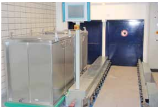
Kuva 6. Asiakkaalle lähtevä kuljetusvaunu on valmis automaattisesti toimivalla kuljetusradalla.
