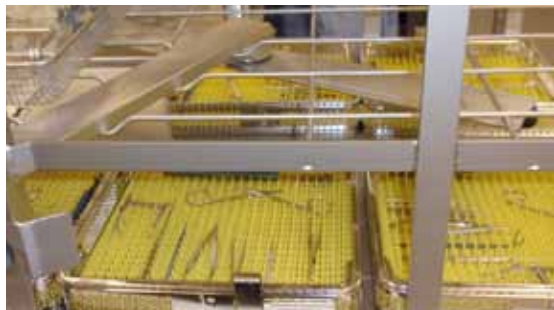
Kuva 1. Herkät instrumentit aseteltiin silikonimatolle, jotta pesu- ja desinfektio-prosessin aikana ne pysyivät hyvin paikallaan.
