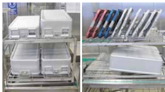
Kuva 3. Kaksi mallikuormaa: sterilointikontaineri ja niiden kansi asetettuna läpianantomallisissa desinfioivissa pesukoneissa (9). Sterilointikontainerit ovat hieman vinossa asennossa veden poistumisen helpottamiseksi pohjasta.
