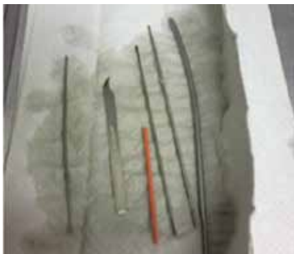
Kuva 3. Erään huuhteludesinfektiokoneen poistoputkesta löytynyttä, myös kertakäyttöinen ompeleenpoistoterä.
