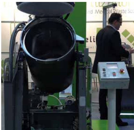
Kuva 2. Biologista jätettä sekä pistävää ja viiltävää jätettä silppuava autoklaavi. Autoklaavin alla nähdään käsiteltävä jätemäärä ennen ja jälkeen prosessin. Prosessin päätteeksi jätteet voidaan hyödyntää energijakeena tai hävittää sekajätteenä. Kuva on Medica 2013 -messuilta Düsseldorfista.
