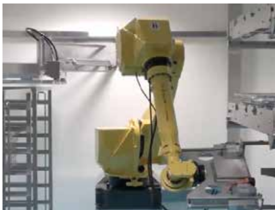
Kuva 3. Robotti huolehtii välinepakkausten varastoinnista ja jakelusta.
