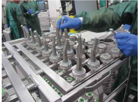
Kuva 5. Turbiinien ja kulmakappaleiden asettelu asianmukaisiin liittimiin hammasvälineiden pesutelineessä.
