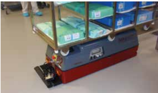
Kuva 6. Pakatut tuotteet lähdössä sterilointiin. Vihivaunu kuljettaa sterilointitelineen höyryautoklaaviin. Vihivaunu purkaa / kuljettaa steriilit välineet sterilointikelkalla autoklaavista steriilitilaan.
