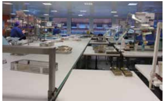
Kuva 5. Desinfioitujen välineiden kuljetus "hihnalla", kunnes välinehuoltaja ottaa instrumenttikorin tai spriikorin pakkauspöydälle koottavaksi. Kun instrumenttikori on tarkastettu ja koottu ohjeen mukaisesti laitetaan se takaisin kuljetushihnalle. Toinen välinehuoltaja ottaa instrumenttikorin ja pakkaa sen suojakääreeseen, josta se sitten etenee sterilointiin.
