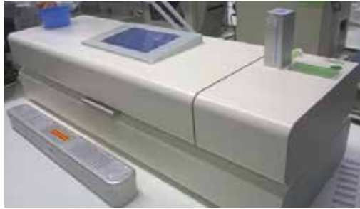
Kuva 6. Jäykkien endoskooppien tarkistuslaite, tähystin laitteen sisällä.
