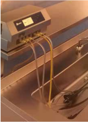
Kuva 11. Taipuisien tähystimien automaattinen esipuhdistuslaite.
