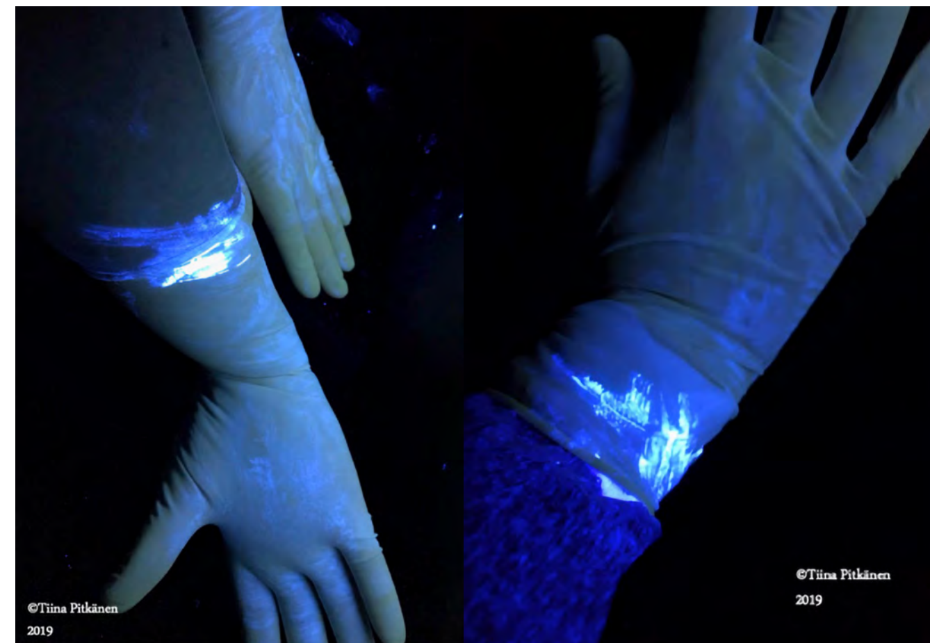
Yleisimmäksi kontaminaatiokohdaksi osoittautui käsineiden varret, mutta kontaminaatiokohtia löytyi myös sormenpäistä ja keskeltä kämmettä.
