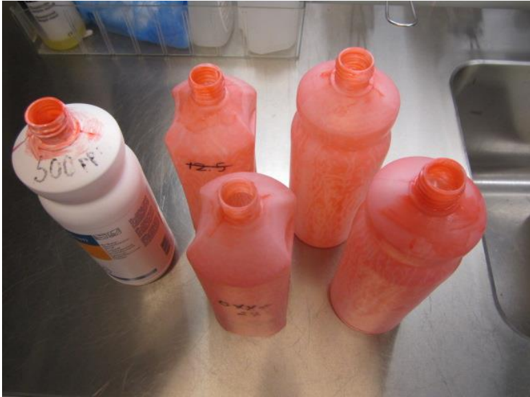
Pullot käsitelty nestemäisellä testiliällä, kuivatusaika 30min
