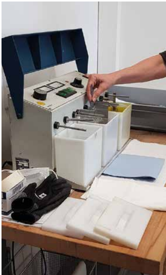
Kuva 4: Neulankuljettajan viimeistely eli kultaus käynnissä.
