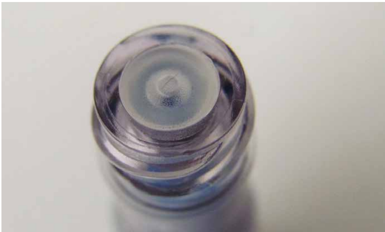
Kuva 2. Neulattoman liittimen pinta
